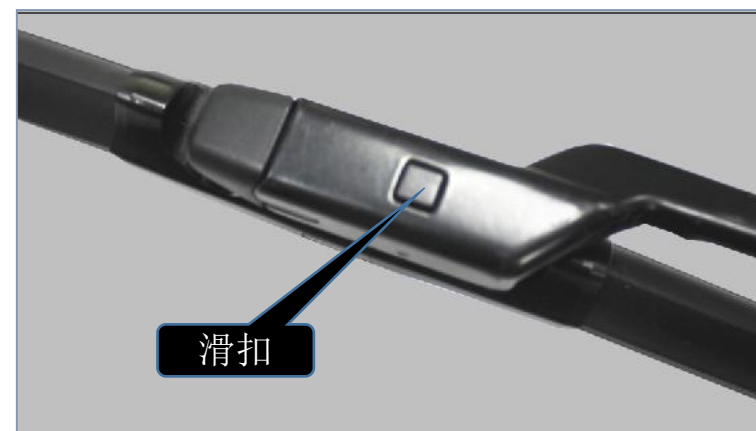
4、将刷头装入摇臂并确保滑扣被锁定
