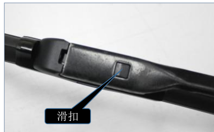
4、将刷头装入摇臂并确保滑扣被锁定
