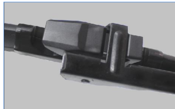
4、旋转刷头与摇臂平齐完成安装
