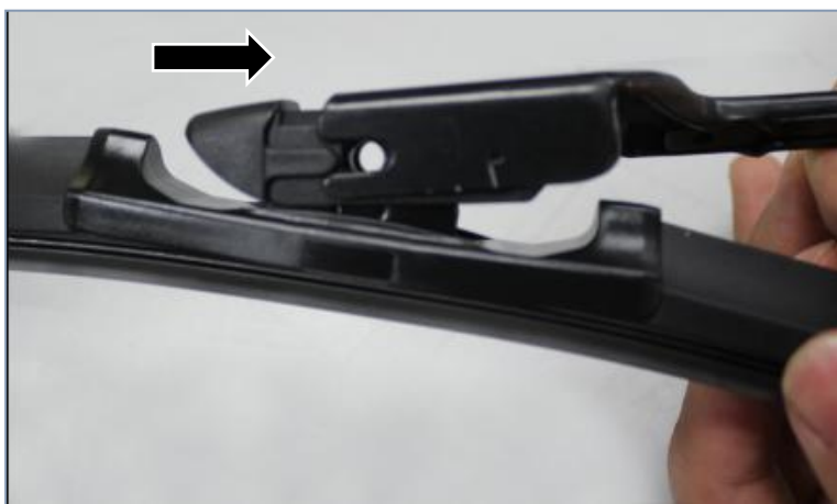
3、旋转刷头至与摇臂平齐并推拉装入摇臂
