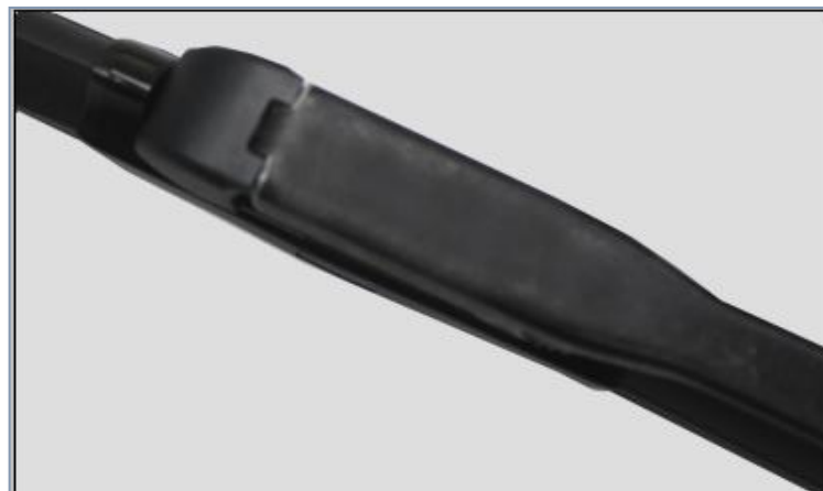
4、确保刷头尾扣锁定摇臂卡位完成安装
