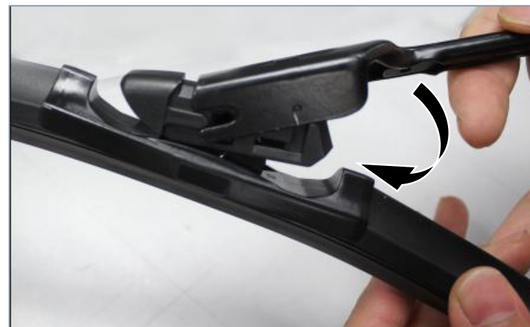
2、倾斜角度将刷头装入摇臂并旋转
