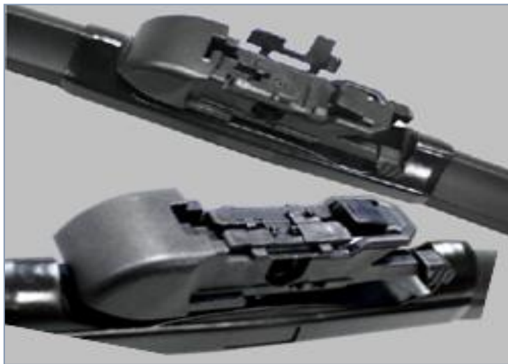
1、上翻刷头两侧翼并确保锁定卡扣机关
