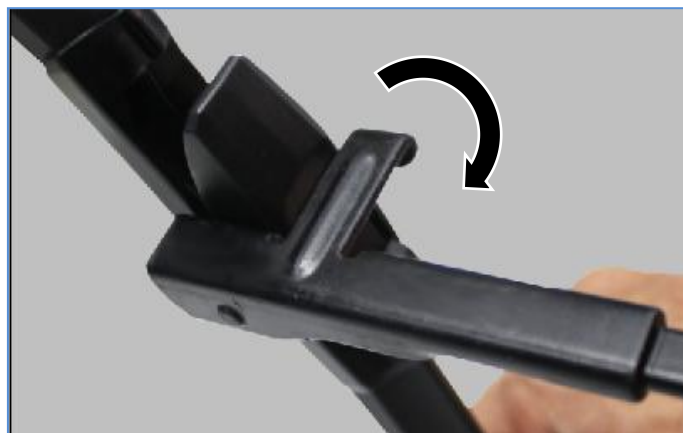
3、将刷头装入摇臂PIN轴并旋转
